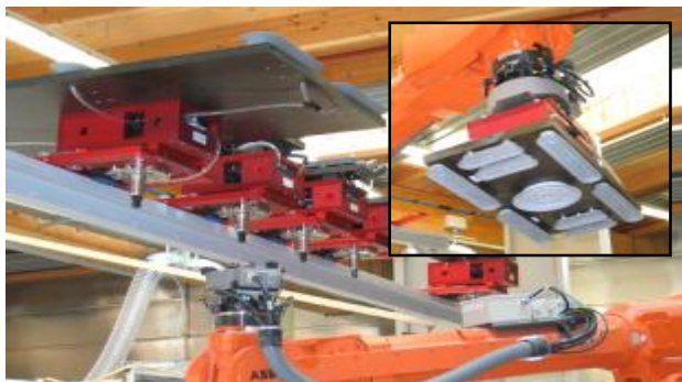
Bilder 6 + 7: Standardisierte Greifer von Wood Unlimited AG auch für schwere Lasten (Bild links)
