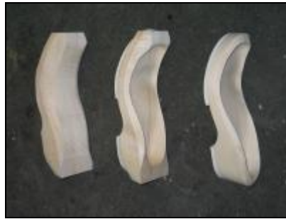
Holzsohlen vor und nach der Bearbeitung durch die Roboteranlage
