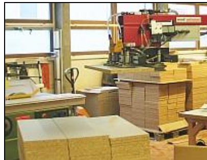
Teileentnahme direkt vom Stapel, ohne Magazinierung und in verschiedenen Stapelbildern
