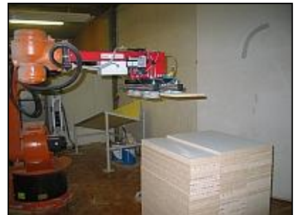
Teileentnahme direkt vom Stapel, ohne Magazinierung und in verschiedenen Stapelbildern
