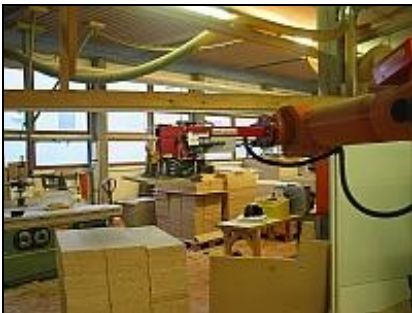
Teileentnahme direkt vom Stapel, ohne Magazinierung und in verschiedenen Stapelbildern
