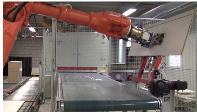
Beschickung grosser Teile über die Wendestation
