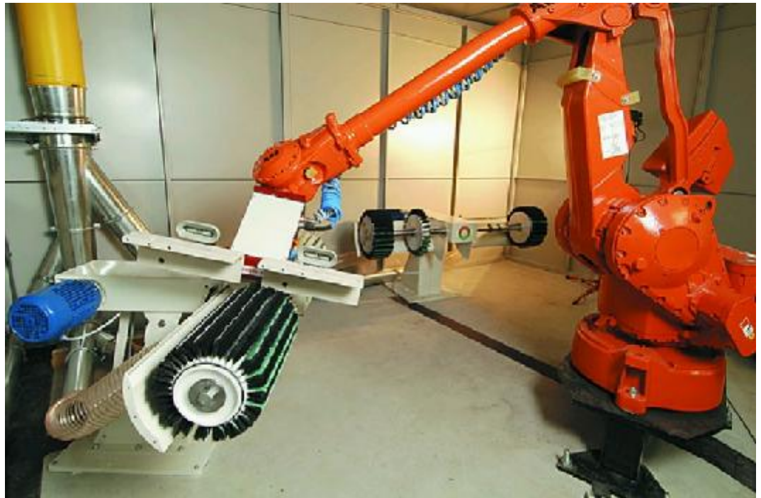
Gleichzeitiges Schleifen von zwei Werkstücken zur Steigerung der Anlagenkapazität
