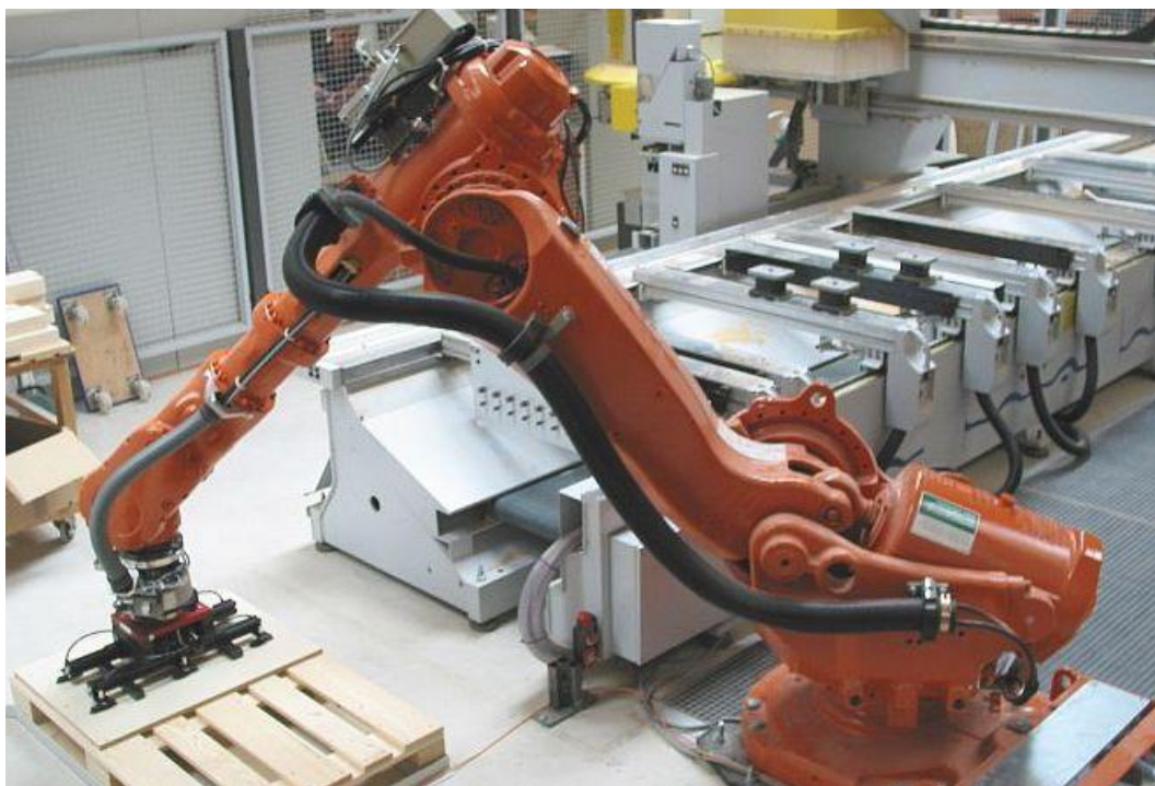
Eine Roboterbeschickung ist auch für bestehende CNC-Anlagen möglich
