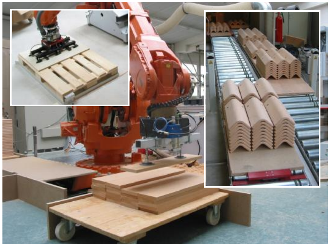
Verschiedene Möglichkeiten der Teilezuführung: Materialwagen, Paletten, Rollenbahnen
